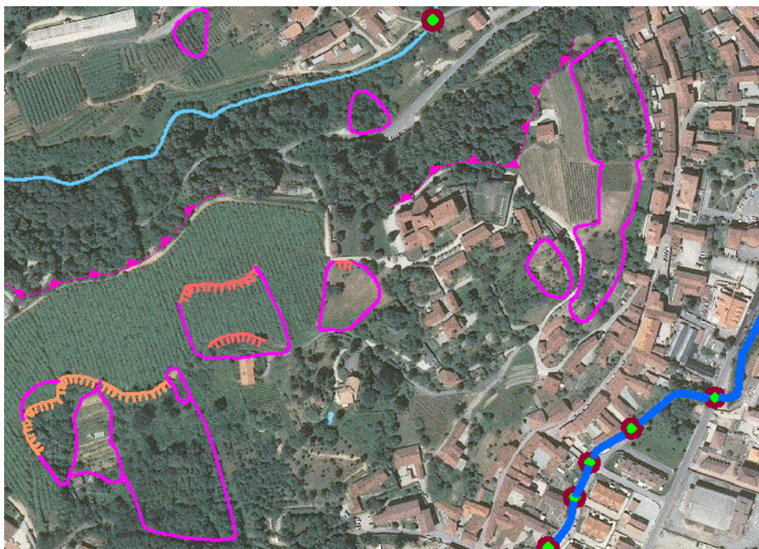
Fig. 15 – Settore collinare del Castello della Manta. Forme di dissesto individuate dalle indagini.
