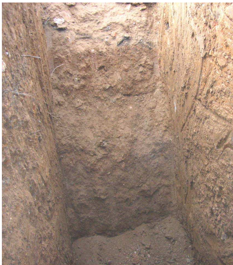
Fig. 13 – Trincea geognostica eseguita presso la S.S. 589.
